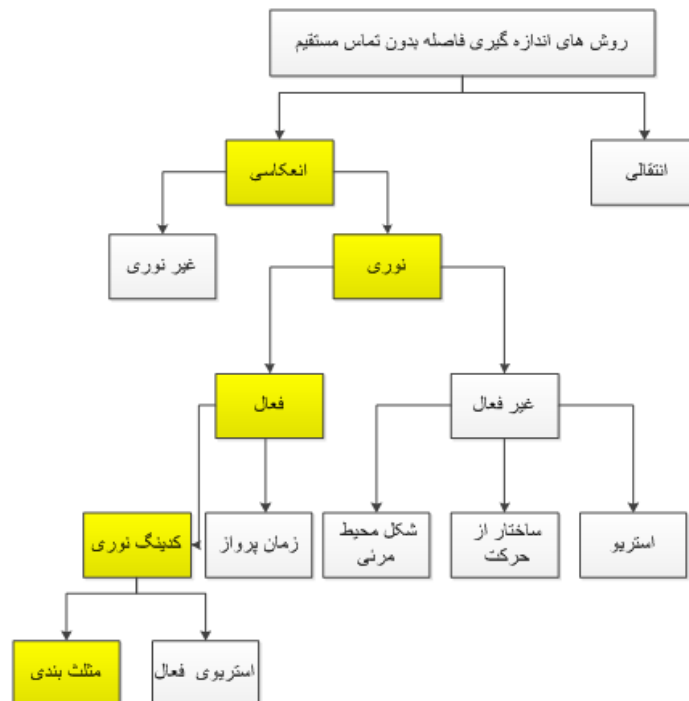
شکل ۱- طبقه بندی روش های اندازه گیری فاصله [۱۴].
