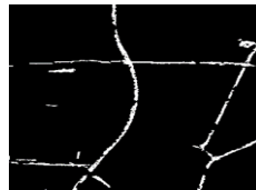
شکل ۷: الف- حذف پارکینگ‌ها از تصویر، ب- اعمال فیلتر به منظور پر شدن گپ‌های تصویر، ج- نتیجه حاصل از اعمال عملگر انسداد مورفولوژی
