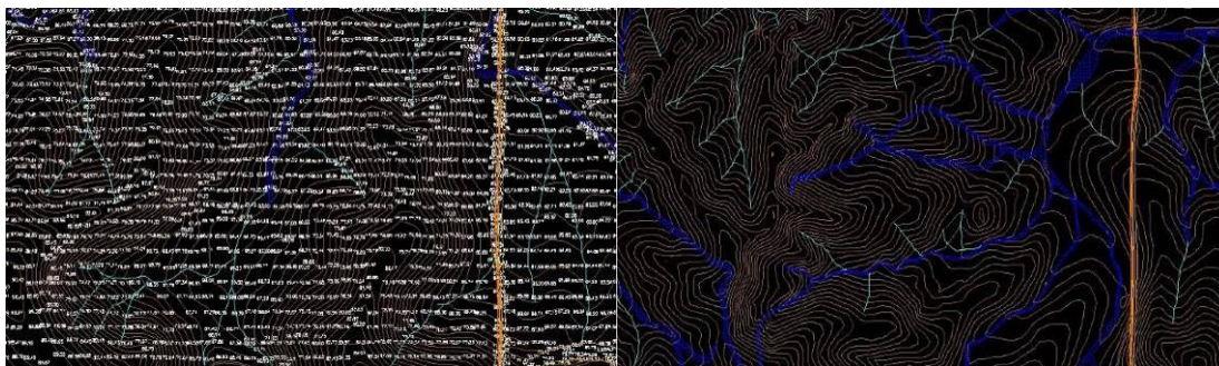
شکل ۱۳: استخراج نقاط ارتفاعی با هر تراکم مورد نظر و منحنی میزان با دقت ارتفاعی بالا از ابر نقاط
