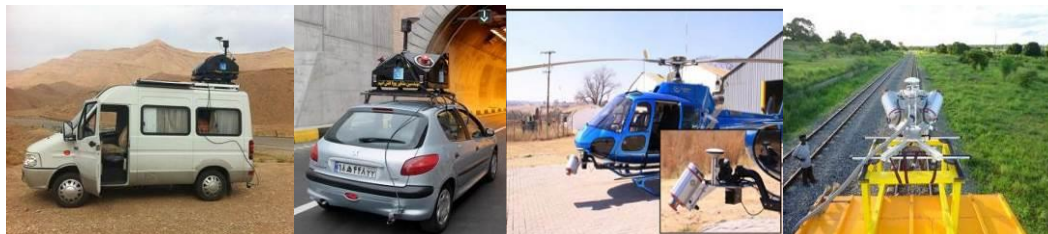
شکل ۳: سکوهای حرکت مختلف برای سامانه StreetMapper
