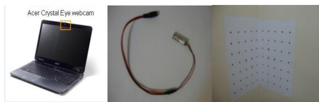
شکل ۸: پنل های کالیبراسیون و لیزر خطی نور قرمز و دوربین مورد استفاده
