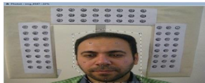
شکل ۴: رفرانس کردن تارگت‌ها، توجیه خارجی، مشخص کردن ناحیه مدلسازی، رفرانس کردن نقاط در قسمت‌های مختلف صورت
