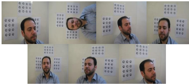
شکل ۶: تصاویر اخذ شده برای مدلسازی نهایی با استفاده از نرم افزار Agisoft
