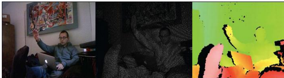
شکل ۵ - (الف) تصویر رنگی؛ (ب) مادون قرمز؛ و (ج) عمق تهیه شده از طریق کتابخانه libfreenect [۴]
